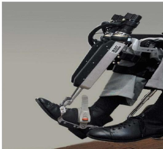
Рисунок 1.33 - Система реабилитации Anklebot
