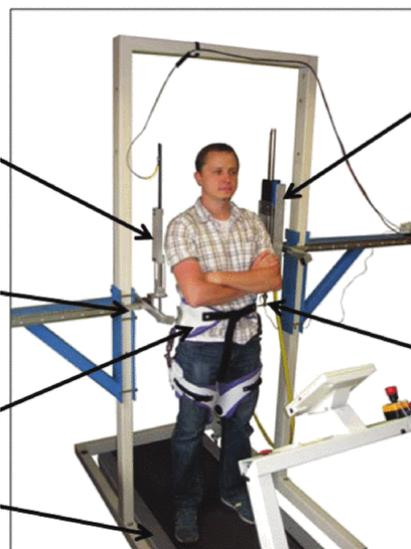
Рисунок 1.8 - Робототехнический тренажер для реабилитации походки RGR
