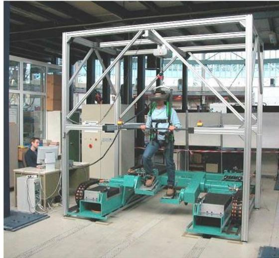
Рисунок 1.12 – Тактильное устройство для симуляции ходьбы HapticWalker
