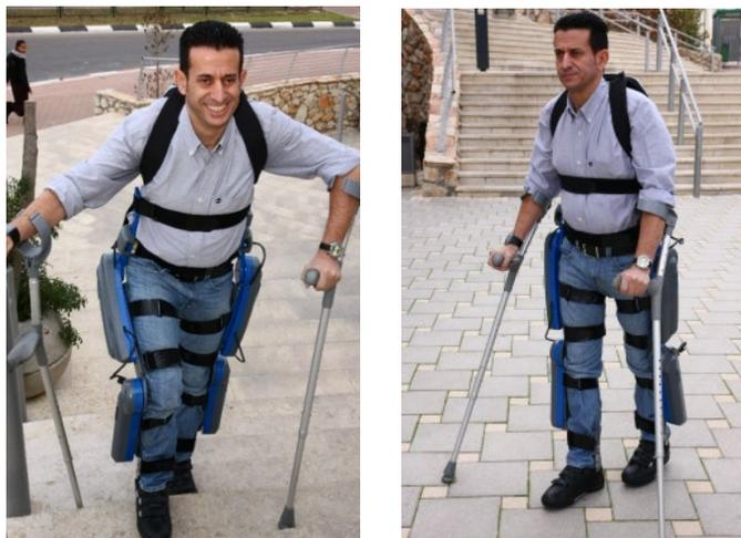
Рисунок 1.21 - Моторизованный экзоскелет ReWalk
