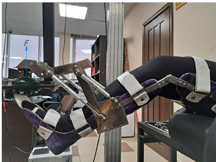
Рисунок 4.7 - Сжатие верхней пары упругих элементов и перемещение ортеза при превышении нагрузки, направленной вдоль оси  $Y$
