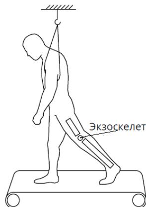
Рисунок 1.1 – Схема РТС на беговой дорожке
