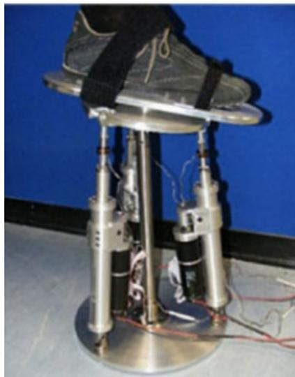
Рисунок 1.29 - Робот для реабилитации голеностопного сустава
