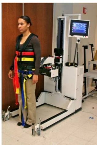
Рисунок 1.19 - РТС для тренировки походки и равновесия KineAssist
