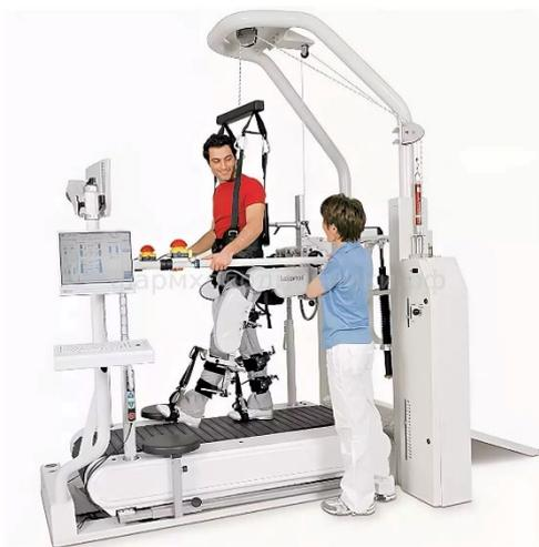
Рисунок 1.2 – Робототехнический ортопедический тренажер Lokomat
