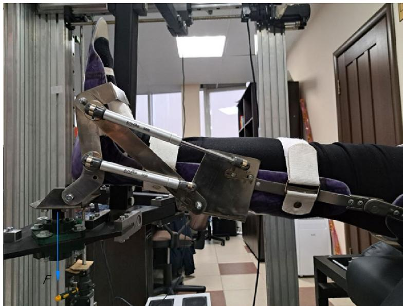
Рисунок 4.8 - Сжатие нижней пары упругих элементов и перемещение ортеза при превышении нагрузки, направленной вдоль оси  $X$
