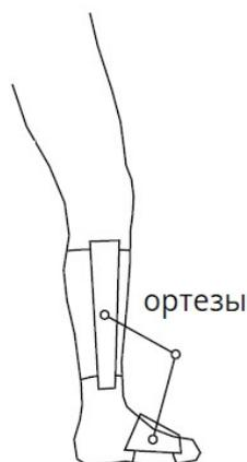
Рисунок 1.31 – Схема активного ортеза для реабилитации голеностопного сустава
